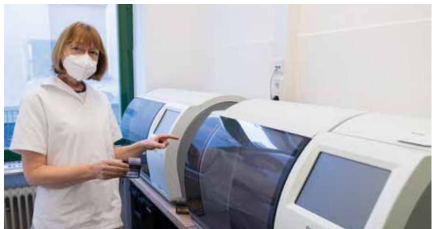
Michaela Ott mit zwei neuen Philips-Scannern. Jeder kann mit bis zu 300 Objektträgern befüllt werden, die er vollautomatisch – also auch über Nacht – scannen kann. Der Scanningvorgang bei 40-facher Vergrößerung dauert pro Objektträger zwei bis drei Minuten
