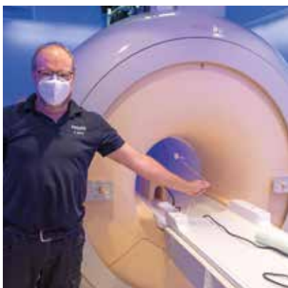
Klaus Merkt lässt eine in Papier gewickelte Münze im Magnetfeld des MRT-Gerätes schweben. Der Magnet in dem Gerät hat eine Stärke von 3 Tesla. Zum Vergleich: Das Erdmagnetfeld hat 0,00005 Tesla, ein normaler Hufeisenmagnet 0,1 Tesla
