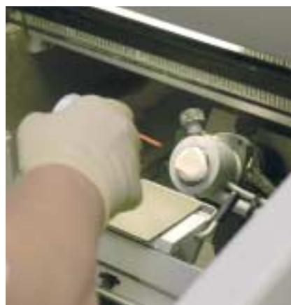
Mithilfe des Gefriermikrotoms lassen sich hauchdünne Schnitte herstellen
