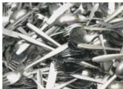
Die Besteckteile werden maschinell in einem Mais-Granulat bewegt. Dadurch lösen sich alle Ablagerungen
