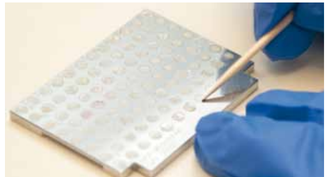
... und auf eines der Probenfelder der Targetplatte übertragen. Diese hat Platz für bis zu 96 Proben, die somit in einem einzigen Arbeitsgang analysiert werden können
