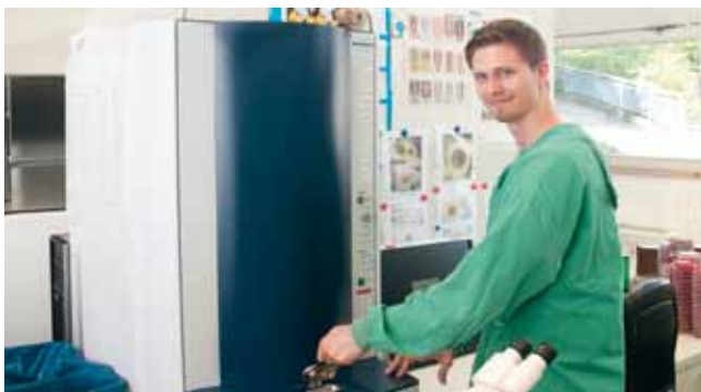
MTLA Sebastian Nagel setzt die Targetplatte in die Vakuumschleuse des MALDI-TOF-Gerätes. Von dort wird sie in dessen luftleere Analyseröhre befördert
