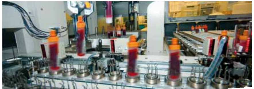
Blutproben werden im Präanalytik-Modul vollautomatisch bearbeitet
